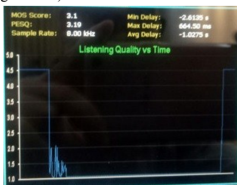
Hình 19. Chất lượng thoại theo chuẩn PESQ được đo kiểm tự động trên thiết bị U8903B
