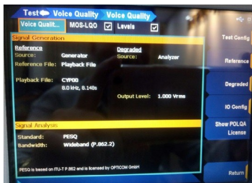
Hình 18. Thiết lập cấu hình tham số máy đo và file đầu vào trên thiết bị U8903B
