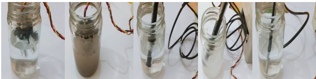
(a) Đo độ đục mẫu nước sinh hoạt (b) Đo độ đục mẫu nước thải (c) Độ PH mẫu nước sinh hoạt (d) Độ PH mẫu nước thải (e) Đo nhiệt độ mẫu nước
