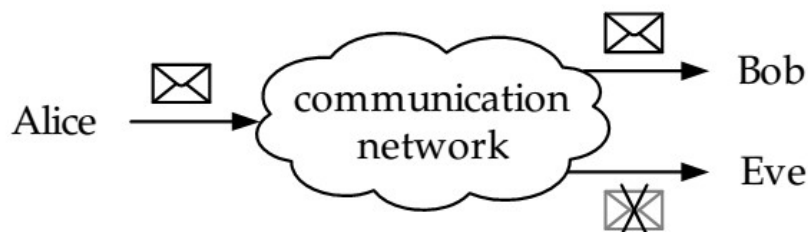
Hình 1: Mô hình hệ thống truyền tin với Alice là người gửi, Bob là người nhận hợp pháp và Eve là kẻ nghe trộm (Eavesdropper).
