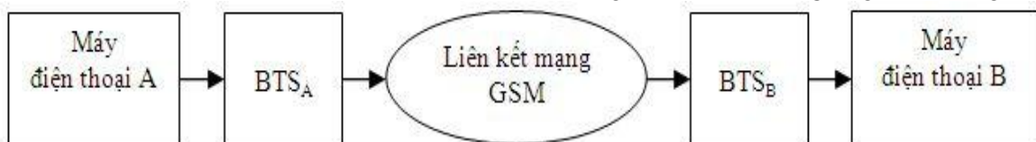
Hình 1. Đường liên kết dữ liệu đơn giản giữa hai máy điện thoại di động
